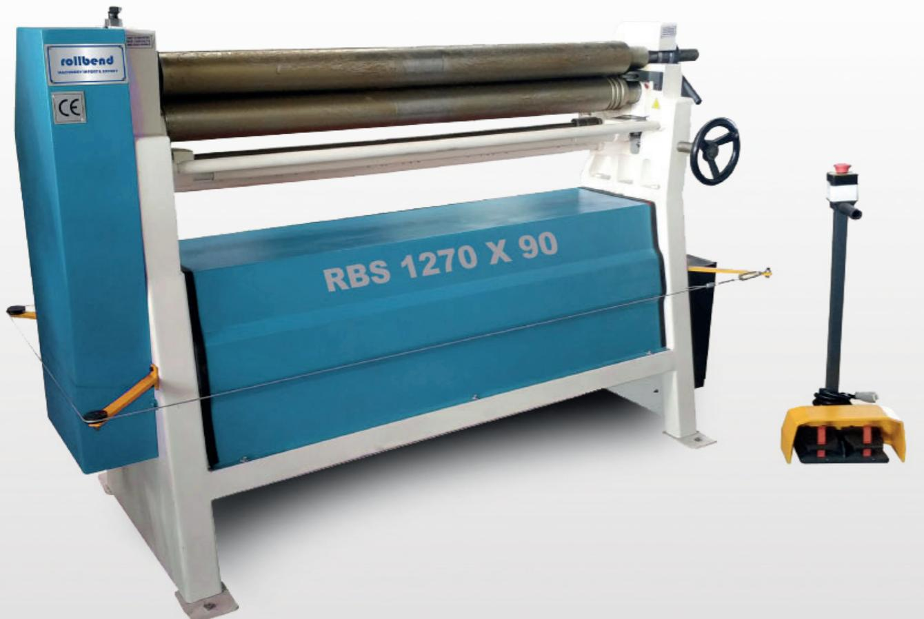
Rollbend silindir makineleri, 1 mm'den 100 mm sac kalınlı ina ve 1000 mm'den 6000 mm sac geni li inde malzemeleri yüksek kalitede istenilen çapta kolay büküm olana i sa lamaktadır.
